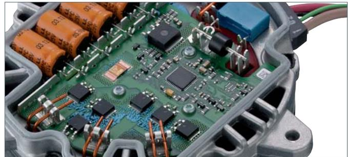
presszone. In der metallisierten Hülse in der Leiterplatte entsteht eine formschlüssige, gasdichte elektrische Verbindung von überlegener Zuverlässigkeit und Langlebigkeit.
