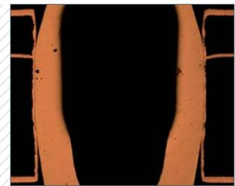
Längsschnitt durch EPZ
