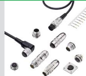
Mit Schraubverschluss M16, 3- bis 14-polig, mit 360°-Schirmung, Löt- und Crimptechnik. Für Signal- und Lastströme bis 5 A.
